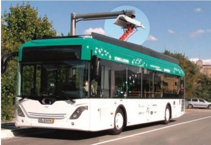
Abbildung 22 Ladestelle mit Schunk-Pantograph (Foto: [samochodyelektryczne.org](http://samochodyelektryczne.org))
